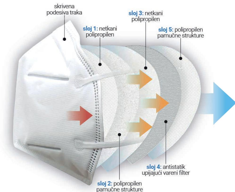
Respiratori se mogu sastojati od 3 do 5 slojeva filtracionog materijala. Na poprečnom presjeku prikazanom na slici možemo videti od čega se sastoji jedan industrijski respirator.
